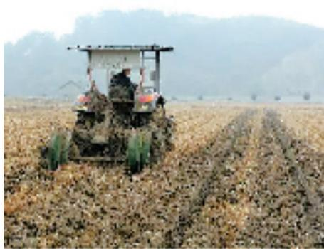
非常普遍,开沟机的机械原理并不复杂,而农民能巧妙地把2台开沟机同时安装在同一个农机挂件上,形成一件一机开双沟的独特农机具,大大提高了机械化生产效率。
