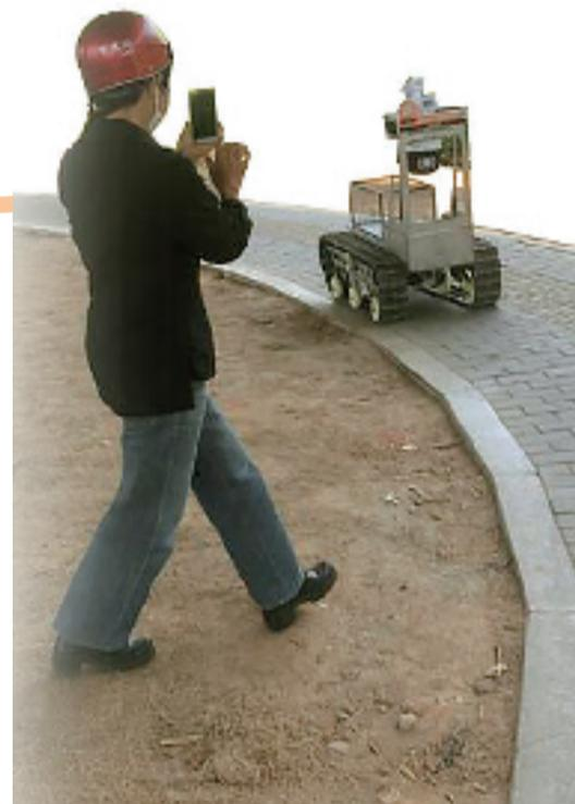
的信号接收器。结合锂电池的使用,在充满电的情况下,机器人可以“闲庭信步”走几十公里。
